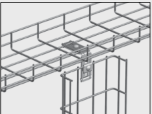
För vertikal avvinkling under trådsteigar, alla bredder, används: 1 st Vinkelbeslag B27 1 st Beslag B1 1 st Beslag B2 2 st Skruvsats B13.
