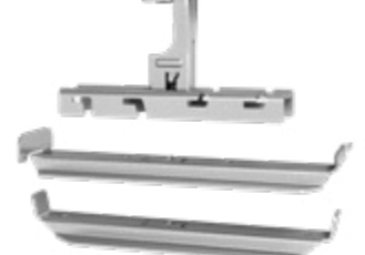
Wibe CLX 3 sovitin asennetaan ensin keskikannakkeeseen. Sitten sovitin ja kannake pikalukitaan CLX 3 kattokannakkeen kiskoon.
